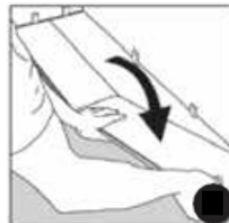
7. Inclinez la planche vers le haut et poussez doucement vers l'avant jusqu'à ce que la planche s'emboîte dans la planche de la rangée précédente. Continuez à installer les planches de la deuxième rangée. Après avoir installé 2 ou 3 rangées, vérifiez l'alignement à l'aide d'un cordeau à craie et ajustez la première rangée si nécessaire en raison d'irrégularités dans le mur de départ.
