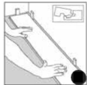
2. Assemblez les joints d'extrémité des planches de la première rangée en insérant la languette dans la rainure de la planche précédente à un angle bas. Abaissez progressivement la planche jusqu'à ce que le joint d'extrémité se ferme, en veillant à ce que les planches soient parfaitement alignées. Installez les planches complètes restantes dans la première rangée.
